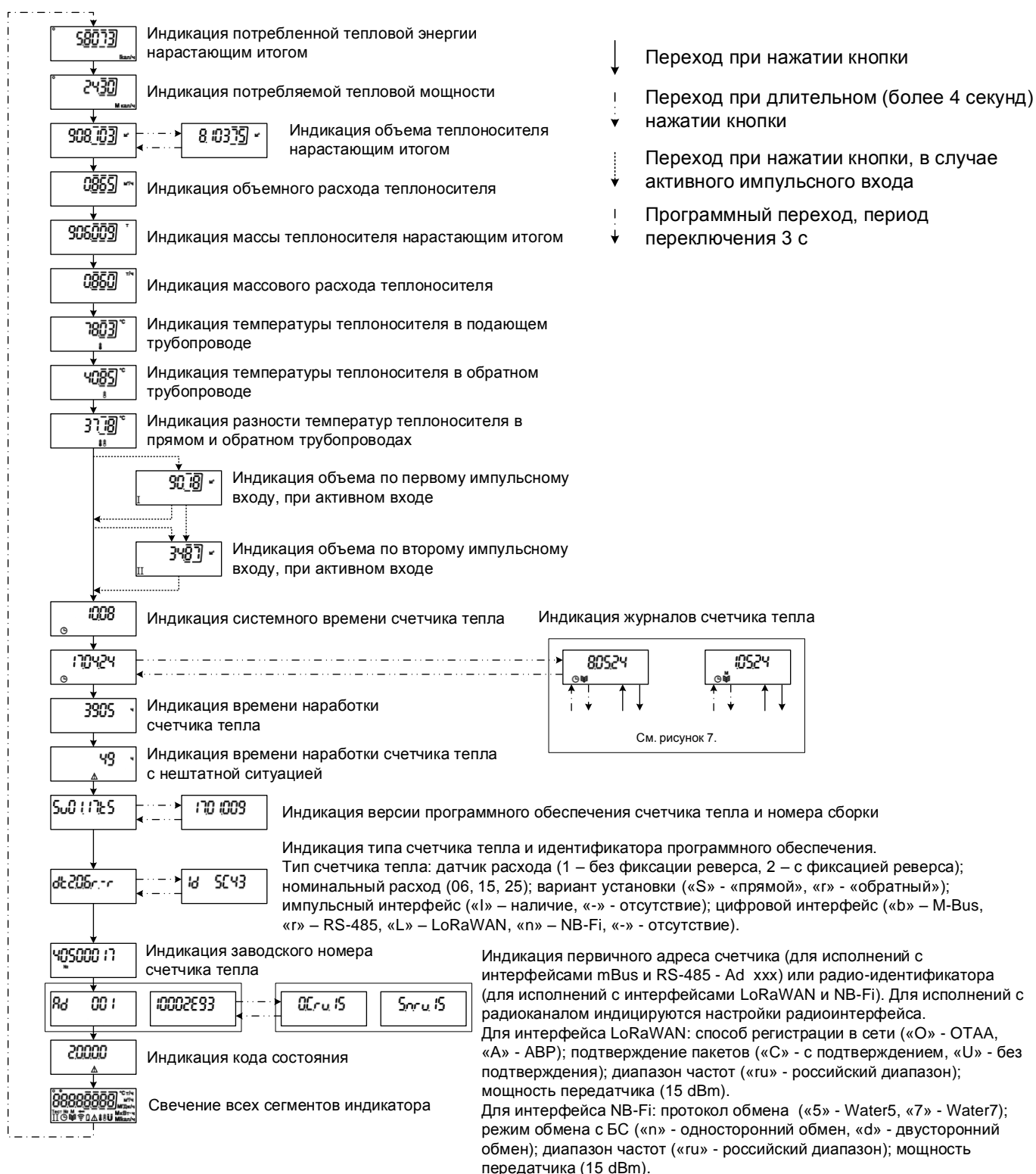
Рисунок 6. Последовательность переключения параметров на индикаторе теплосчетчика.
