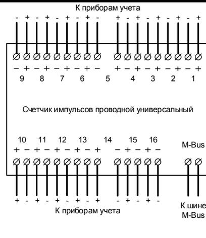
Рисунок А.10 - Схема подключения приборов учета ресурсов к счетчику SET.SIPU.X.16.X.DIN.
