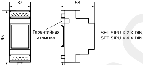
Рисунок А.3 – Внешний вид, габаритные и установочные размеры счётчиков SET.SIPU.X.2.X.DIN, SET.SIPU.X.4.X.DIN
