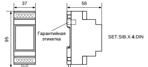
Рисунок А.3 – Внешний вид, габаритные и установочные размеры счётчиков SET.SIB.X.4.DIN
